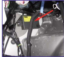
**SEGNALATORE ACUSTICO:** Fissare il buzzer sulla piastra di metallo sotto al cruscotto lato guida.
