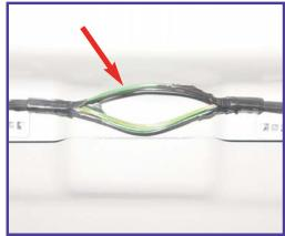
**NEGATIVO:** Per il collegamento elettrico individuare il filo NERO nel fascio di cavi nel vano ruota di scorta nel baule.
