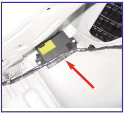
**SEGNALATORE ACUSTICO**: Fissare il segnalatore acustico (buzzer) sopra il supporto cintura di sicurezza dietro al pannello baule lato guida.
